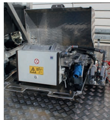
Sistema accionamiento 230 V E-DRIVE con bomba gemela
