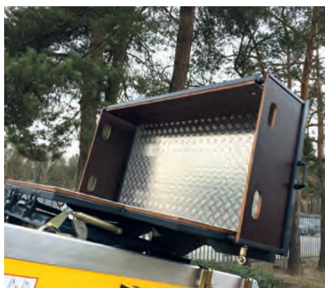
Plataforma par apartes de andamio
